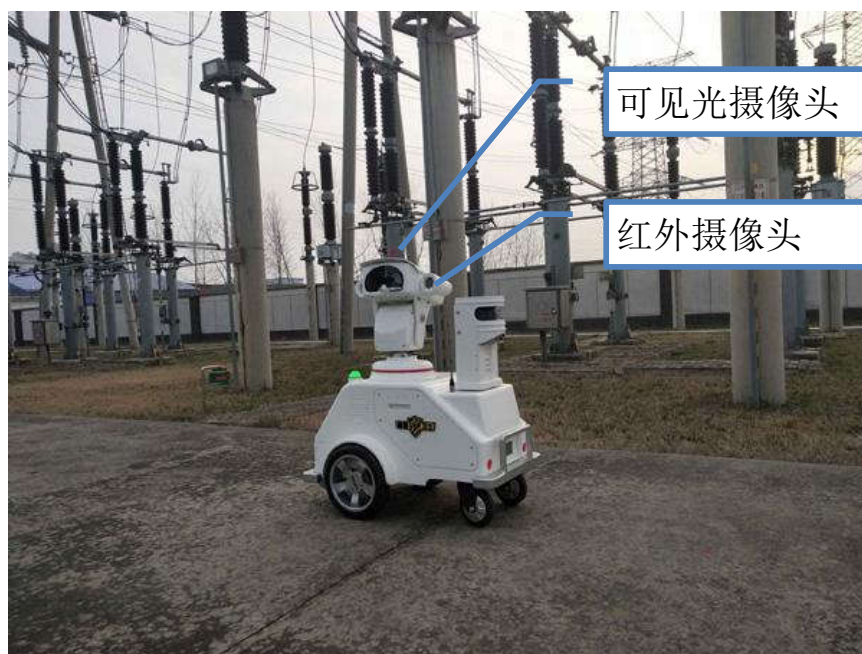
电力巡检机器人
